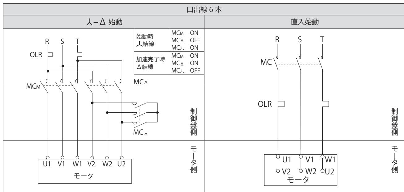
MC : 電磁接触器
