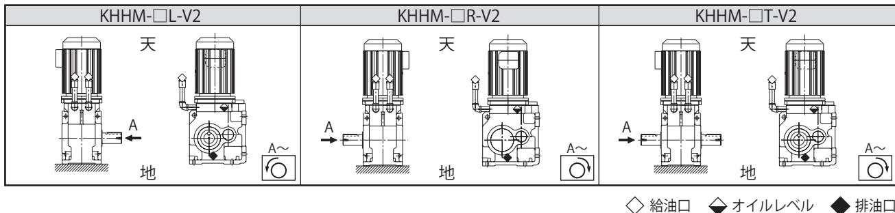
図 5-5 出力軸回転方向と給排油口位置（中実軸・脚取付形、床面取付）
