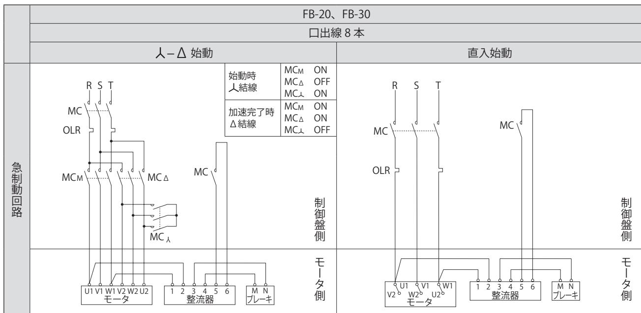
MC : 電磁接触器
