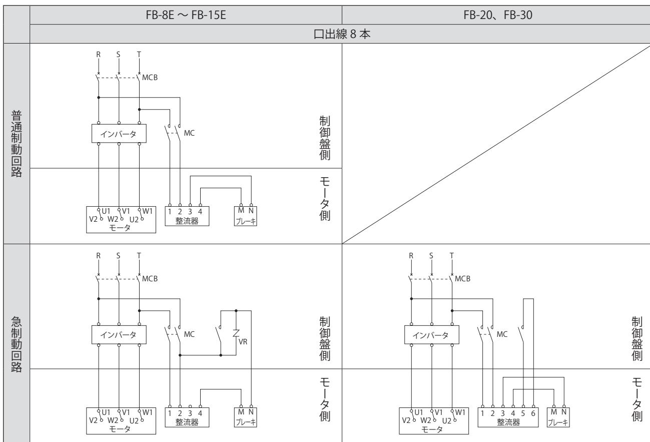
MC : 電磁接触器
