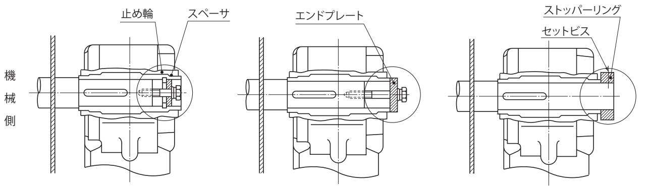
図5-11 本製品が反機械側に動かない固定方法例
