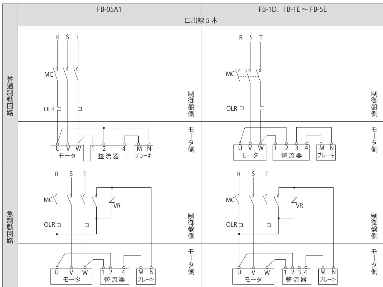
MC : 電磁接触器
