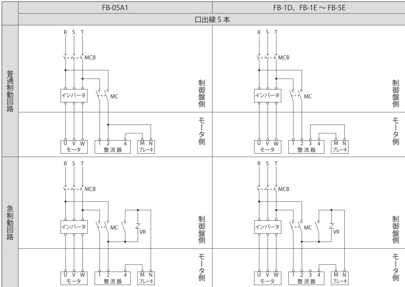
MC : 電磁接触器
