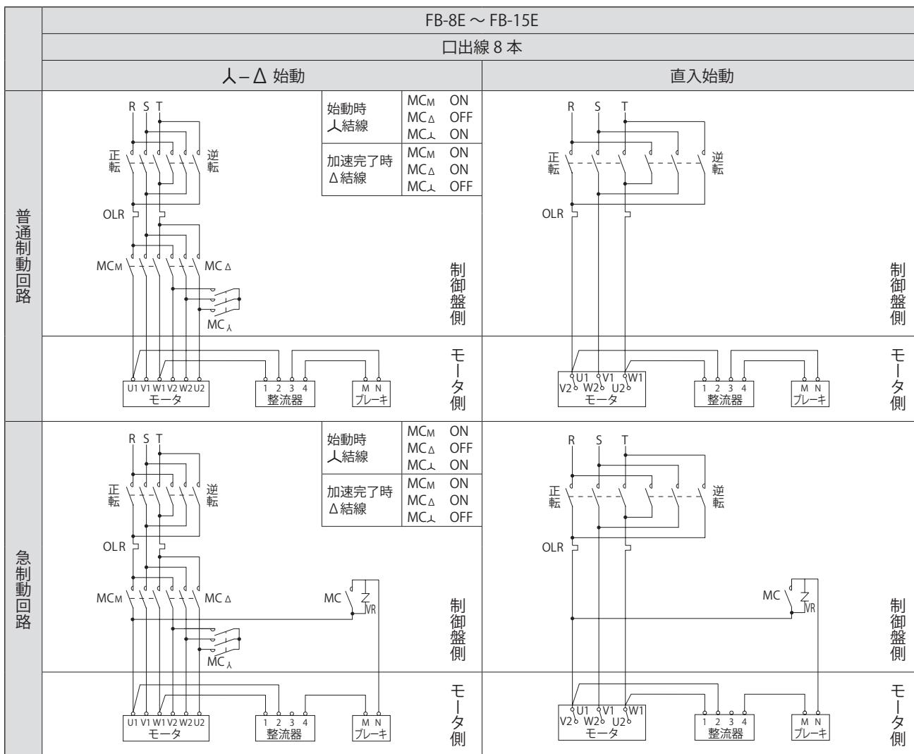
正・逆転用電磁接触器
