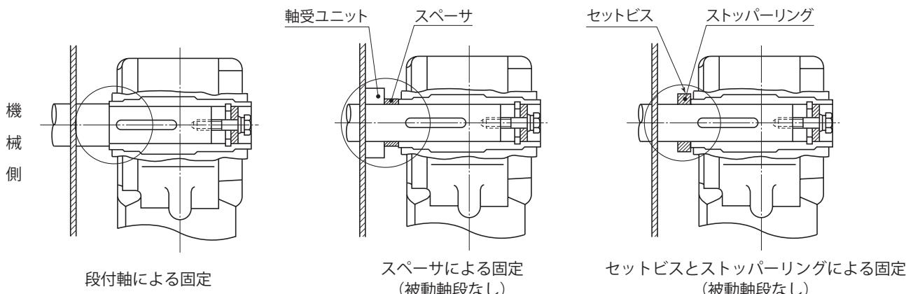
図5-10 本製品が機械側に動かない固定方法例
