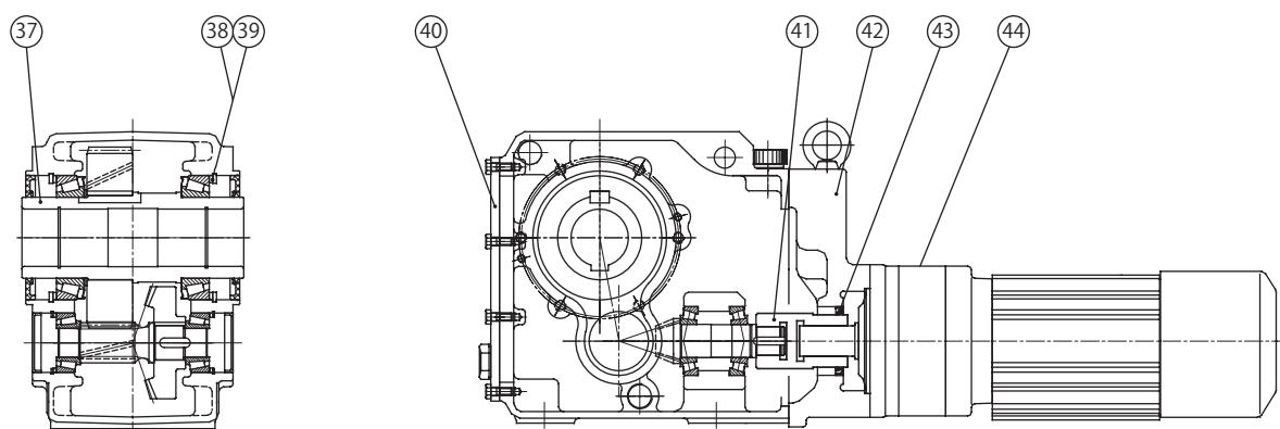
図 10-2 KHYM 形（ギヤモータ）（例：枠番 72DA-Y1）
