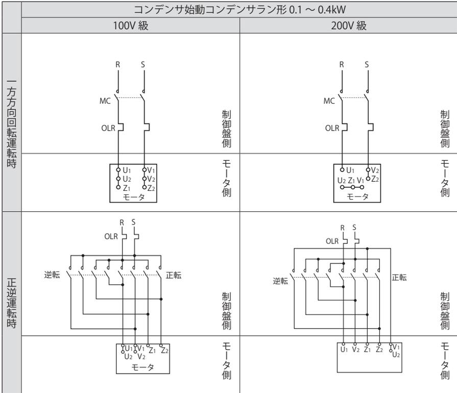
MC：電磁接触器
