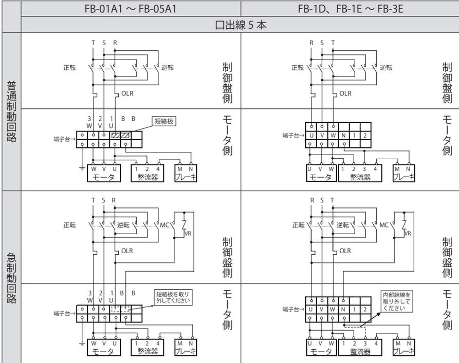
正・逆転用電磁接触器
