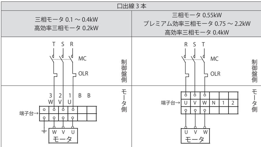
MC : 電磁接触器
