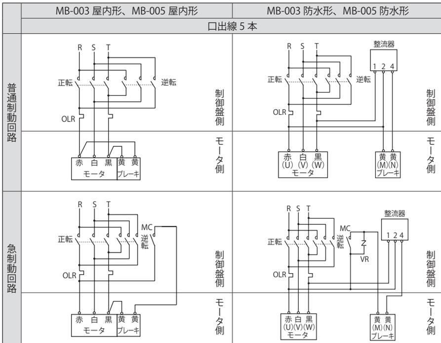
正・逆転用電磁接触器
