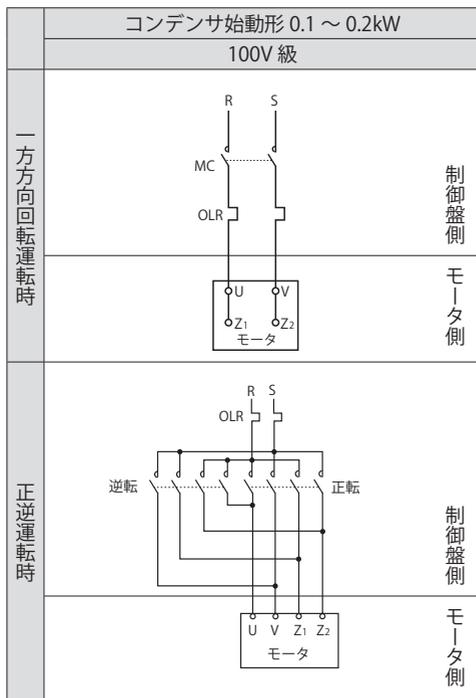
MC : 電磁接触器
